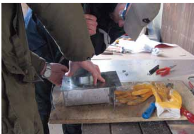
Slika 3. Na osnovi kartonskega modela izdelamo nastavek (škatlo) iz pločevine (dele zlepimo in zatesnimo s silikonskim kitom), ki ima na eni strani izrezano odprtino in pritrženo rozeto za namestitve plastične cevi.
