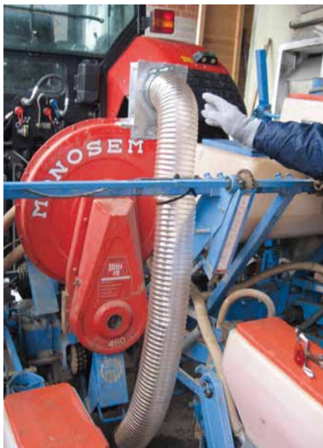
Slika 6. Končni izgled pravilno predelane podtlačne sejalnice za setev tretiranega semena koruze.
