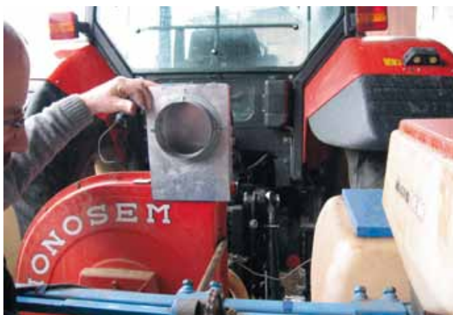
Slika 4. Nastavek pritrđimo na odprtino za iztok zraka na ohišju sejalnice in zatesnimo.
